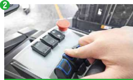
Maston työntö eteenpäin
