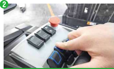
Maston työntö eteenpäin
